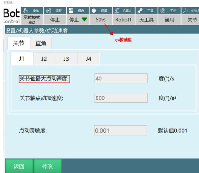
机器人实际点动速度就是： $\{VJ\}=40^{\circ}/s * 50\%=20^{\circ}/s$
