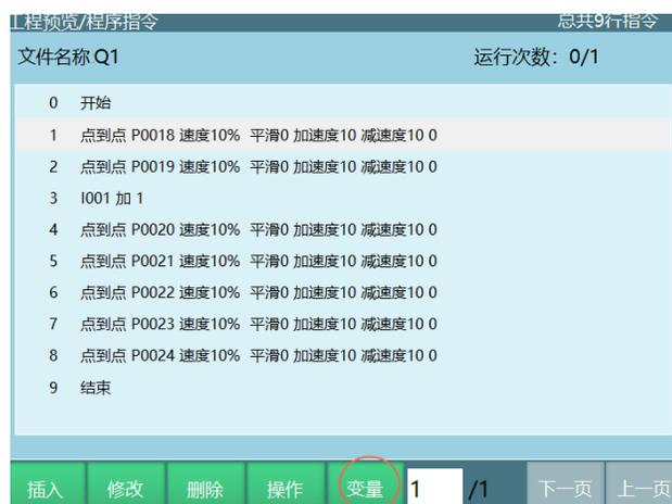
数值型变量储存的是数值，包含了整数型变量、实数型变量、布尔型和字符型变量四种。
