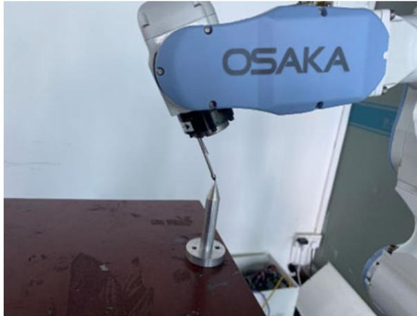
第四个点：机器人回到零点，然后工具手末梢垂直
