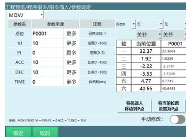
当前位置列显示当前选中的坐标系下的机器人位置;P0001列显示P点选中坐标系下的机器人位置
