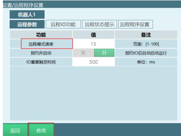
2. 点击【修改】，修改远程模式速度
