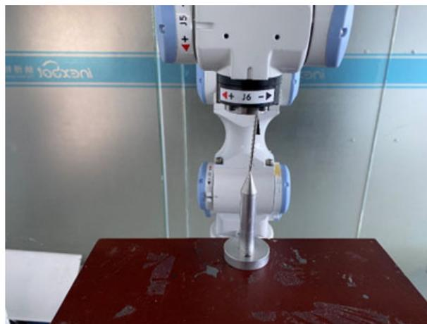
第三个点: 机器人在第一点的基础上 B 轴角度在 35°
