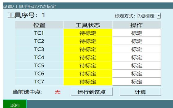
若没有工具的详细参数, 可以进行 TCP 标定, 自动计算出工具各项尺寸参数。具体标定步骤如下:
