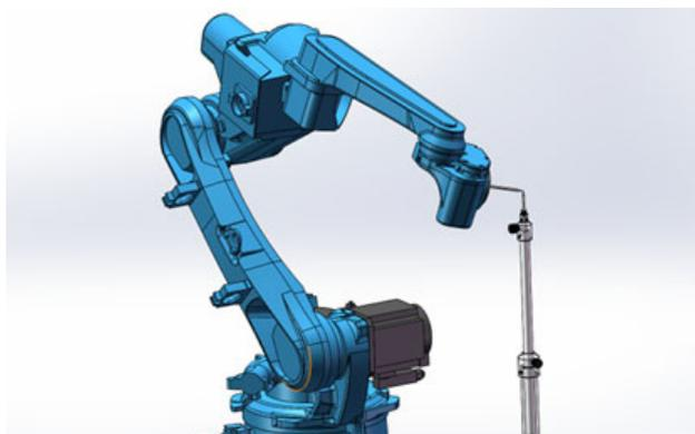
第十二点机器人在第十点的基础上，通过直角坐标系做 A-，旋转  $90^\circ$ ， $J5 < -90^\circ$ ，尖端对齐，标定第十二点；
