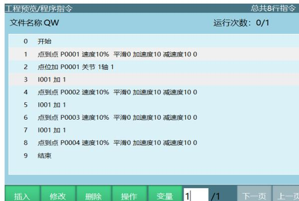
运行到第 6 行时 P0001 J1=1、I001=2，切换示教模式产生断点，切换到示教模式后查看 P0001,I001 显示为初始值，此时按【DEADMAN】上电，显示为 P0001 J1=1、I001=2，下电恢复初始值
