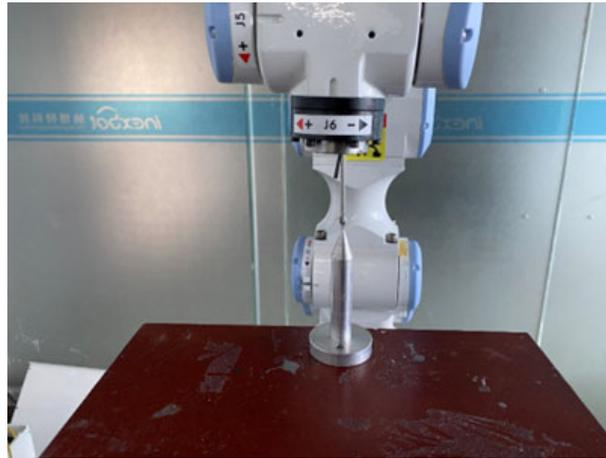
第二个点: 机器人在第一点的基础上 C 轴旋转 180°
